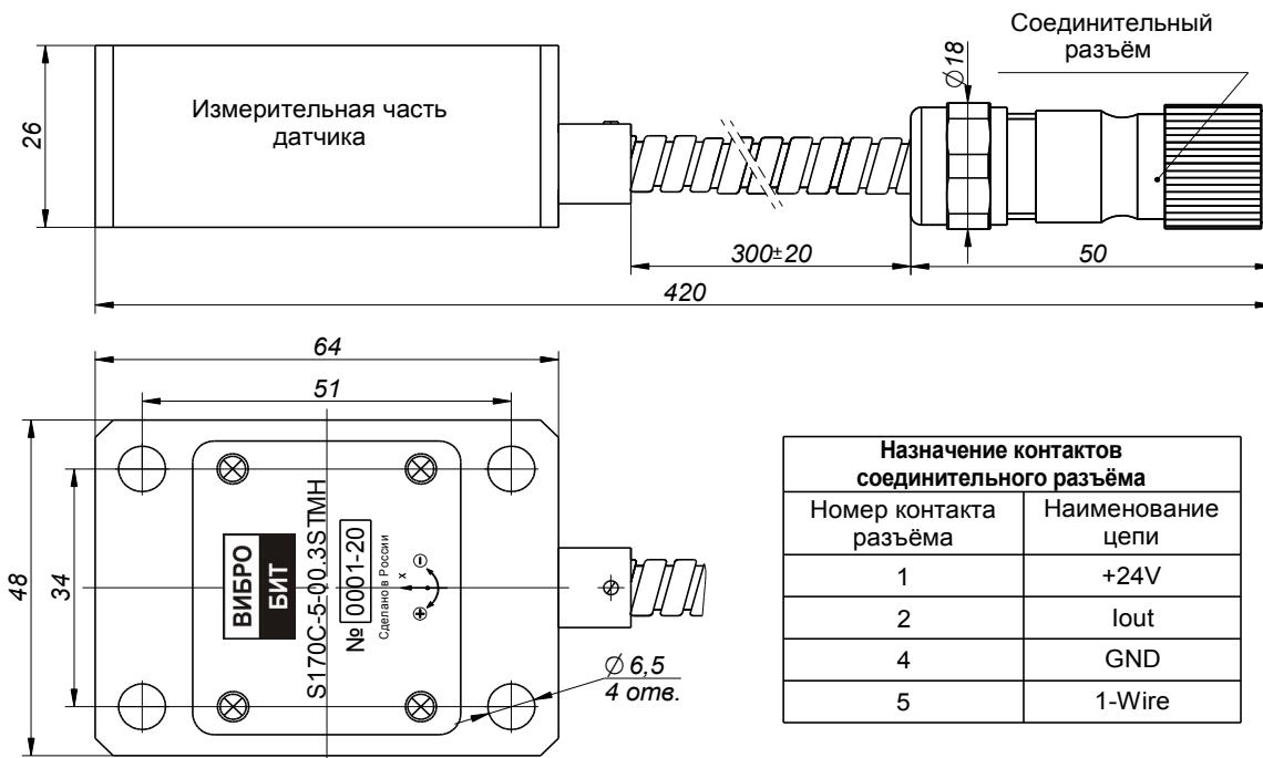
Рис. 1 — Внешний вид Датчика\*
