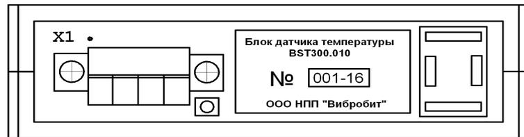
Рисунок 26 – Внешний вид блока датчика температуры BST300.010
