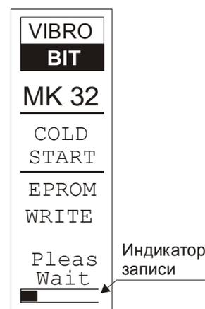
Рисунок 7. Процесс записи в энергонезависимую память настроек по умолчанию
