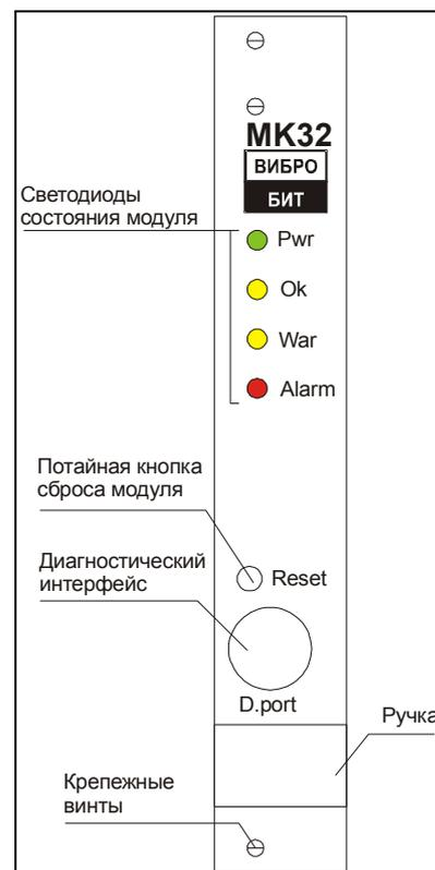
Рисунок 1. Лицевая панель 'DC' модуля МК32
