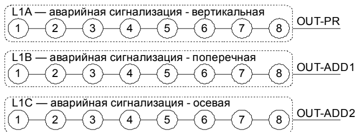
Рисунок 19 - Логическая схема (S1=OFF, S2=ON, S3=OFF, S4=OFF, S5=OFF, S6=ON)
