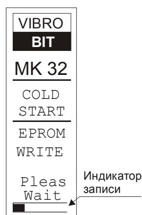
Рис. 11: Процесс записи в энергонезависимую память настроек по умолчанию
