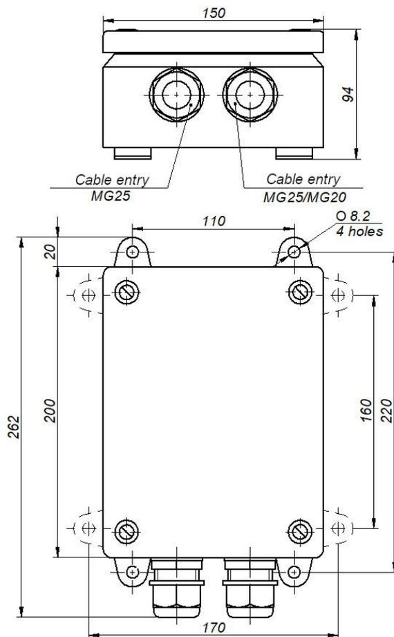
Figure C.40 – Transducer boxes КП13Р, КП13КР
