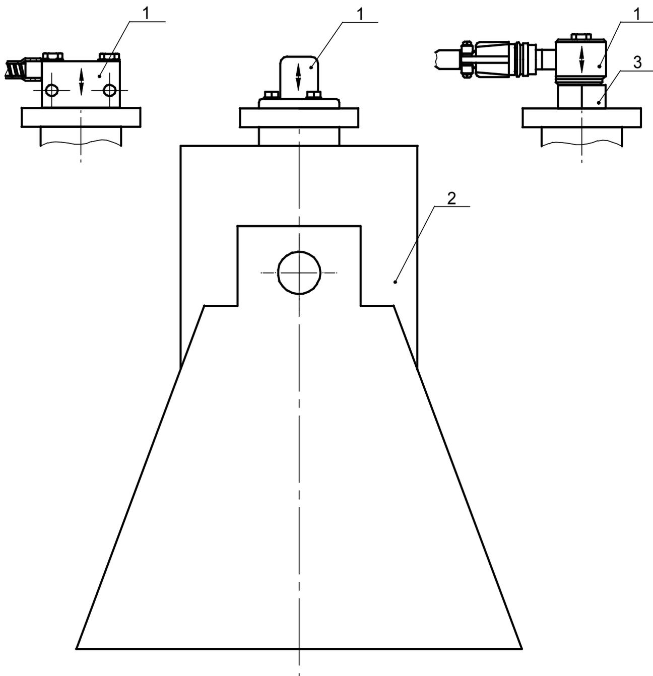
1– Sensor ДПЭ22МВ, ДПЭ22МВТ, ДПЭ22П, ДПЭ22Ex, ДПЭ23МВ, ДПЭ23МВТ, ДПЭ23П, ДПЭ23Ex, 625В01, ДПЭ24;
