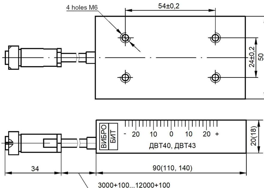
Figure C.6 – Sensors ДВТ40.10, ДВТ40.20, ДВТ43.20, ДВТ40.30, ДВТ43.30, ДВТ40.50, ДВТ43.50
