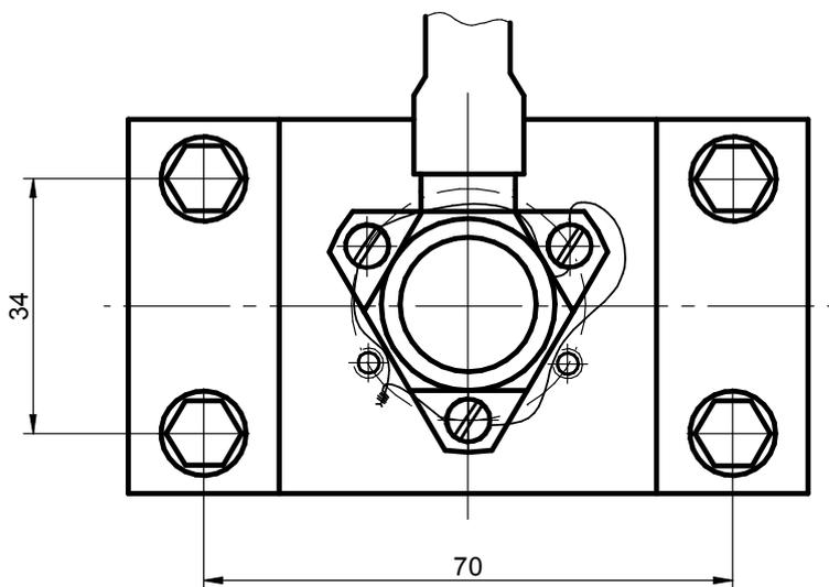
Figure K.19 – Installation of sensors ДПЭ22МВ, ДПЭ22МВТ, ДПЭ22Ех, ДПЭ23МВ, ДПЭ23МВТ, ДПЭ23Ех
