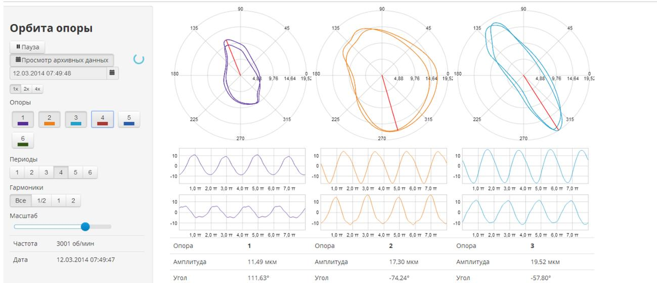
Рис. 10 – Орбита движения центра ротора по датчикам вибрации опор
