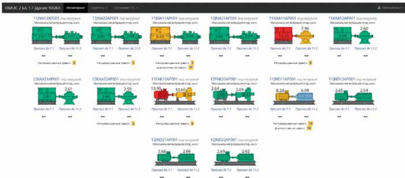
Рис. 4. ИСВМ «Вибробит Web.Net.Monitoring»: рабочее окно
