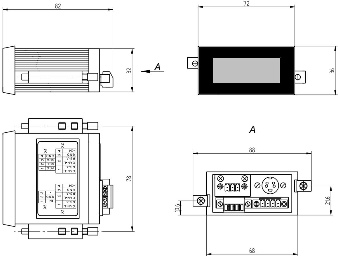
Рисунок А.1 - Блок индикации БИ34
