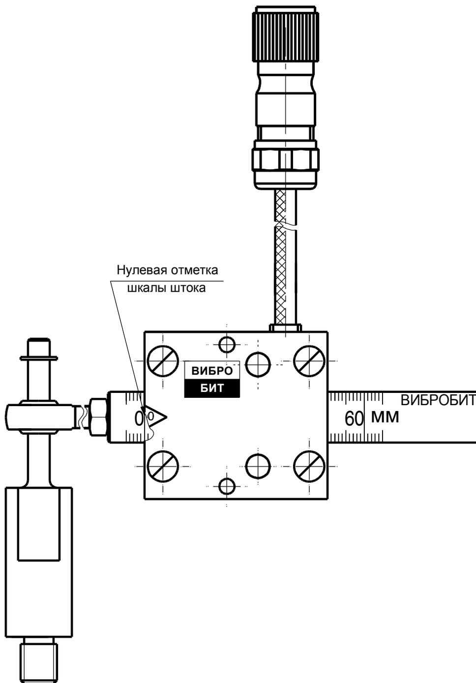
Рисунок Г.1 – Установка нулевого положения датчиков S150С, S150Е, S151Е
