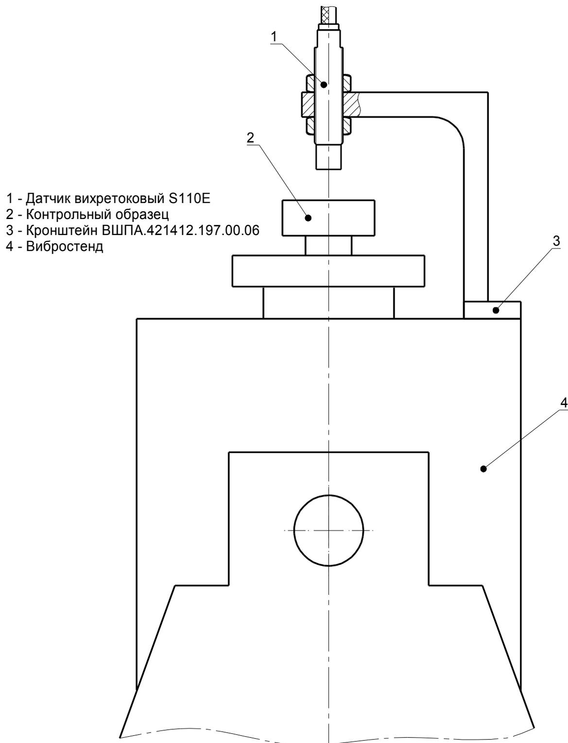
Рисунок Д.1 – Установка датчиков S110E, S110C, S120E, S120C на вибростенде
